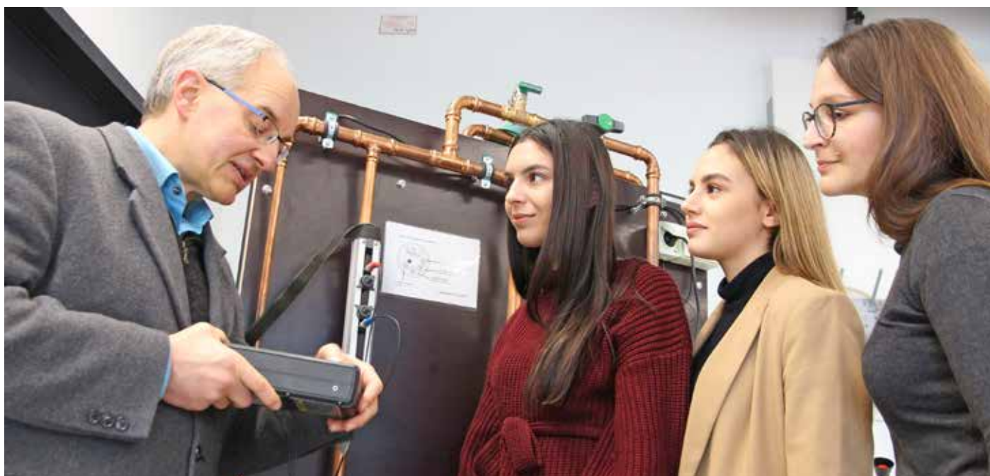
Prof. Hans-Martin Seipp erläutert ein Prüfsystem zur Messung der Strömungsgeschwindigkeit in Trinkwasserleitungen. Die Bachelorstudentinnen Pakize Peynir, Asena Bingöl und Katja Birnstein (von links) hören aufmerksam zu.
