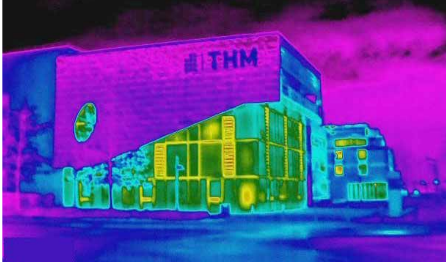
Das Thermografiebild vom Café Campustor in der Gießener Wiesenstraße zeigt, wo die Wärmeverluste am größten sind.
