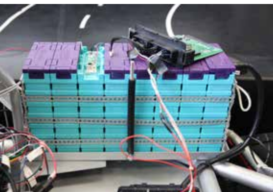
Lithium-Ionen-Batteriepack mit der Elektronik zum Ausgleich des Ladezustands einzelner Zellen
