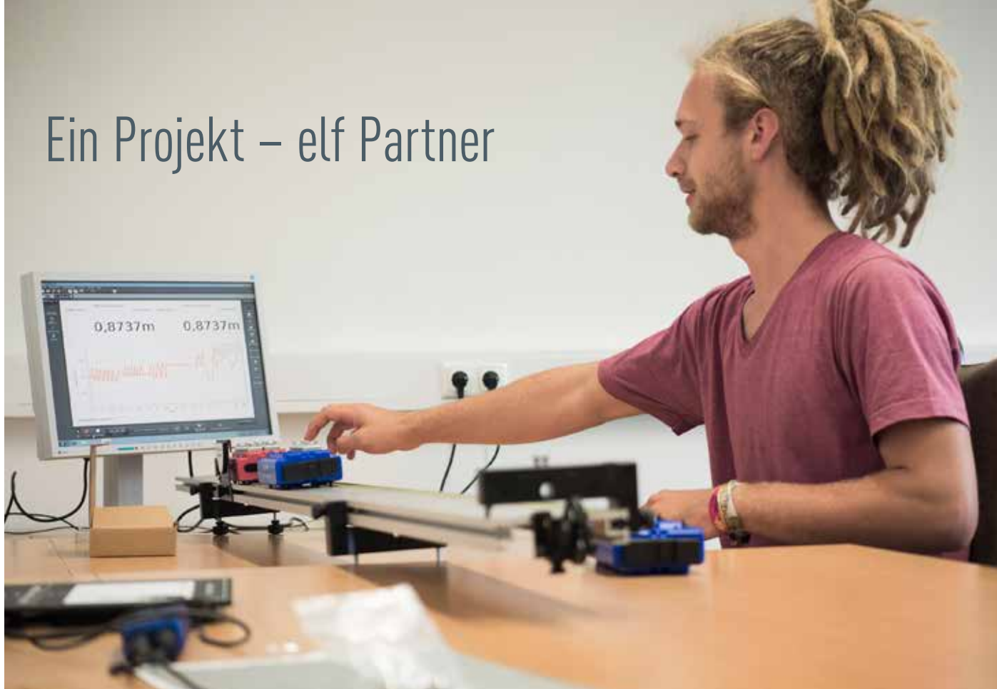
Digitalisierung im Labor: Messung kinetischer Energie bei einem physikalischen Versuch
