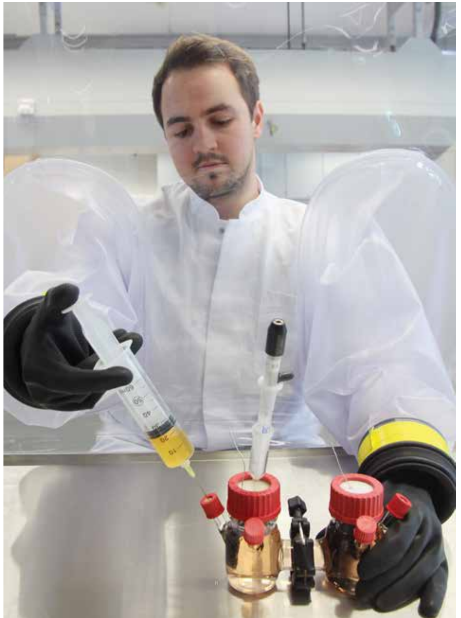
Doktorand Alexander Langsdorf testet die ersten Elektroden, die aus Grünschnitt hergestellt wurden.
