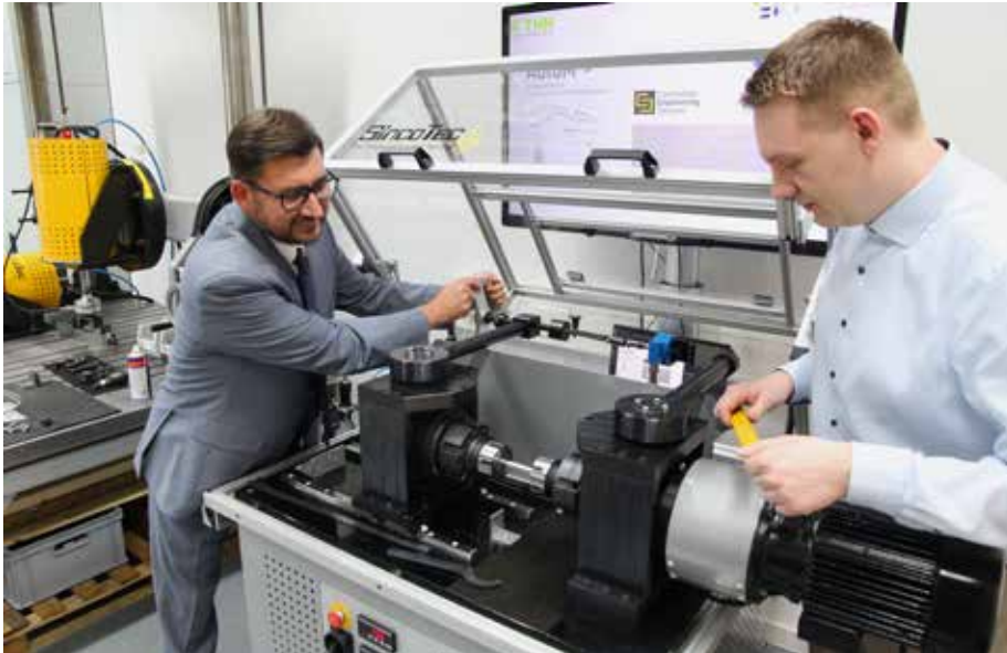
Prof. Udo Jung (links) und Doktorand Andreas Kern bereiten eine Umlaufbiegeprüfmaschine für den Test einer Werkstoffprobe vor.
