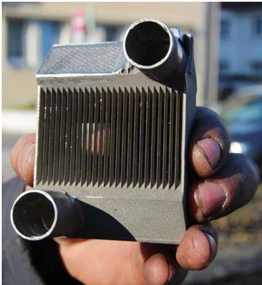
Gedruckt mit dem selektiven Laserstrahlschmelzverfahren: der Prototyp des neuartigen Kühlers
