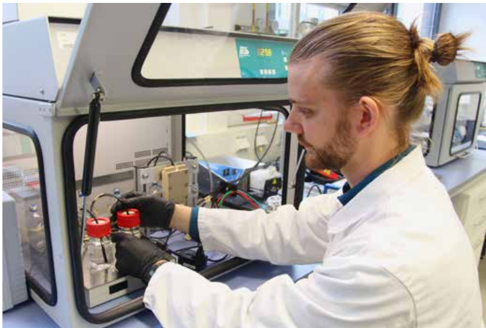
Der Doktorand Björn Sabel startet einen Versuch zur elektrobiotechnologischen Erzeugung von Formiat, das zur Synthese verschiedener Wertstoffe genutzt werden kann.
