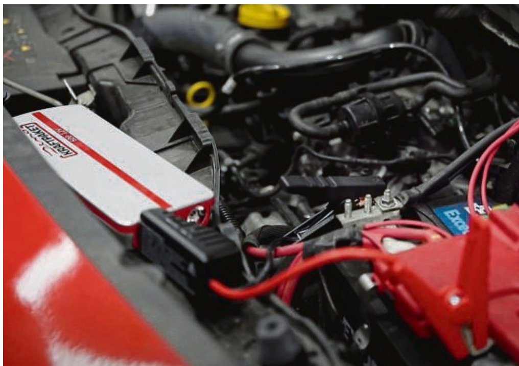
Starthilfe-Booster können einer müden Autobatterie wieder auf die Sprünge helfen.
