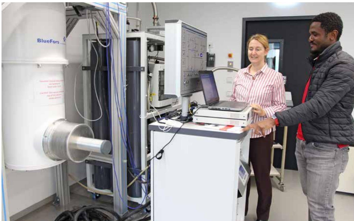
Zur Laborausstattung von Prof. Saskia Kraft-Bermuth und ihrem Wissenschaftlichen Mitarbeiter Willy Dzukam gehört ein Kryostat, der die Detektoren auf ein Hundertstelgrad über dem absoluten Nullpunkt herunterkühlt. Diese niedrige Temperatur ist notwendig, um die geforderte hohe Präzision in der Energiedetektion zu erreichen.
