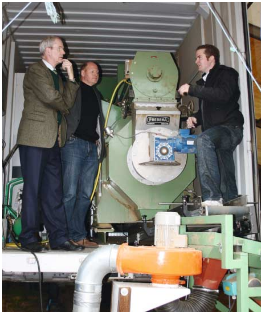
Fabrik im Container: Sebastian Auth erläutert seinen Betreuern Prof. Gerd Manthei und Prof. Rudolf Griemert (von rechts) die mobile Pelletieranlage.
