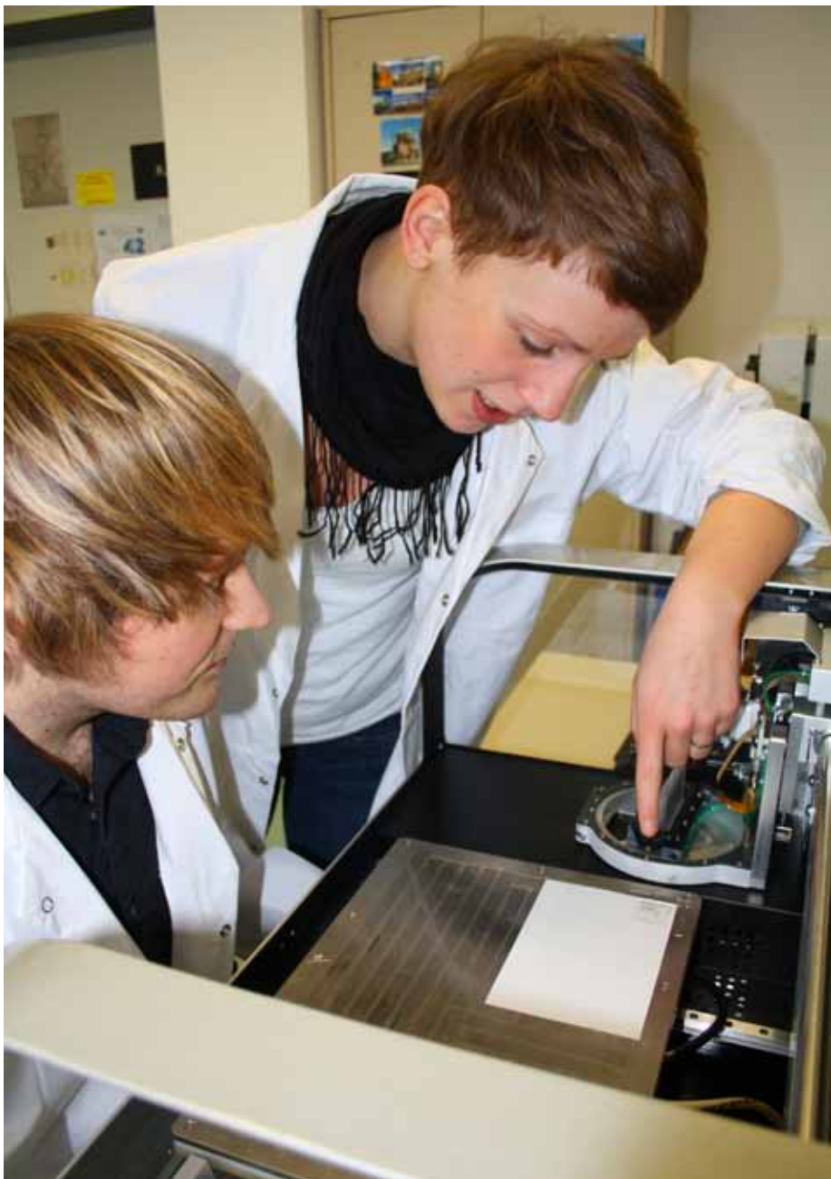
Mit einem speziellen Tintenstrahldrucker stellen die Wissenschaftlichen Mitarbeiter Franziska Hain und Michael Gräf elektronische Bauelemente auf Kunststoffbasis her.
