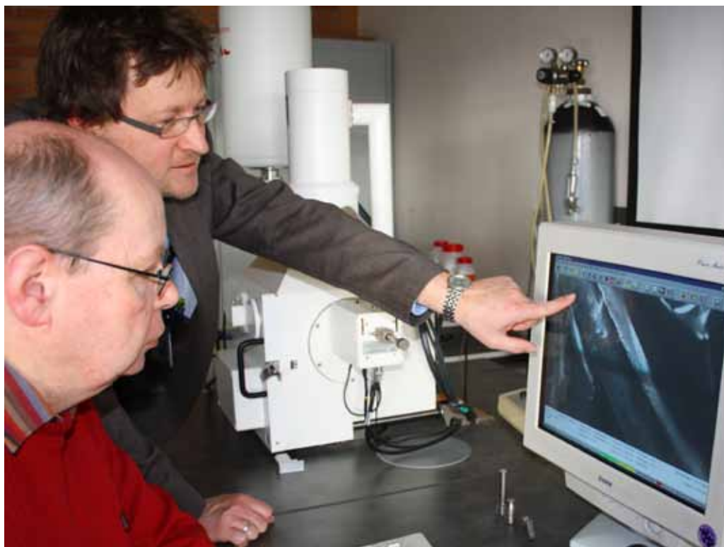
Prof. Jörg Gollnick (hinten) und Labortechniker Lothar Pfeil analysieren am Rasterelektronenmikroskop Bruchbilder von Stahlproben.
