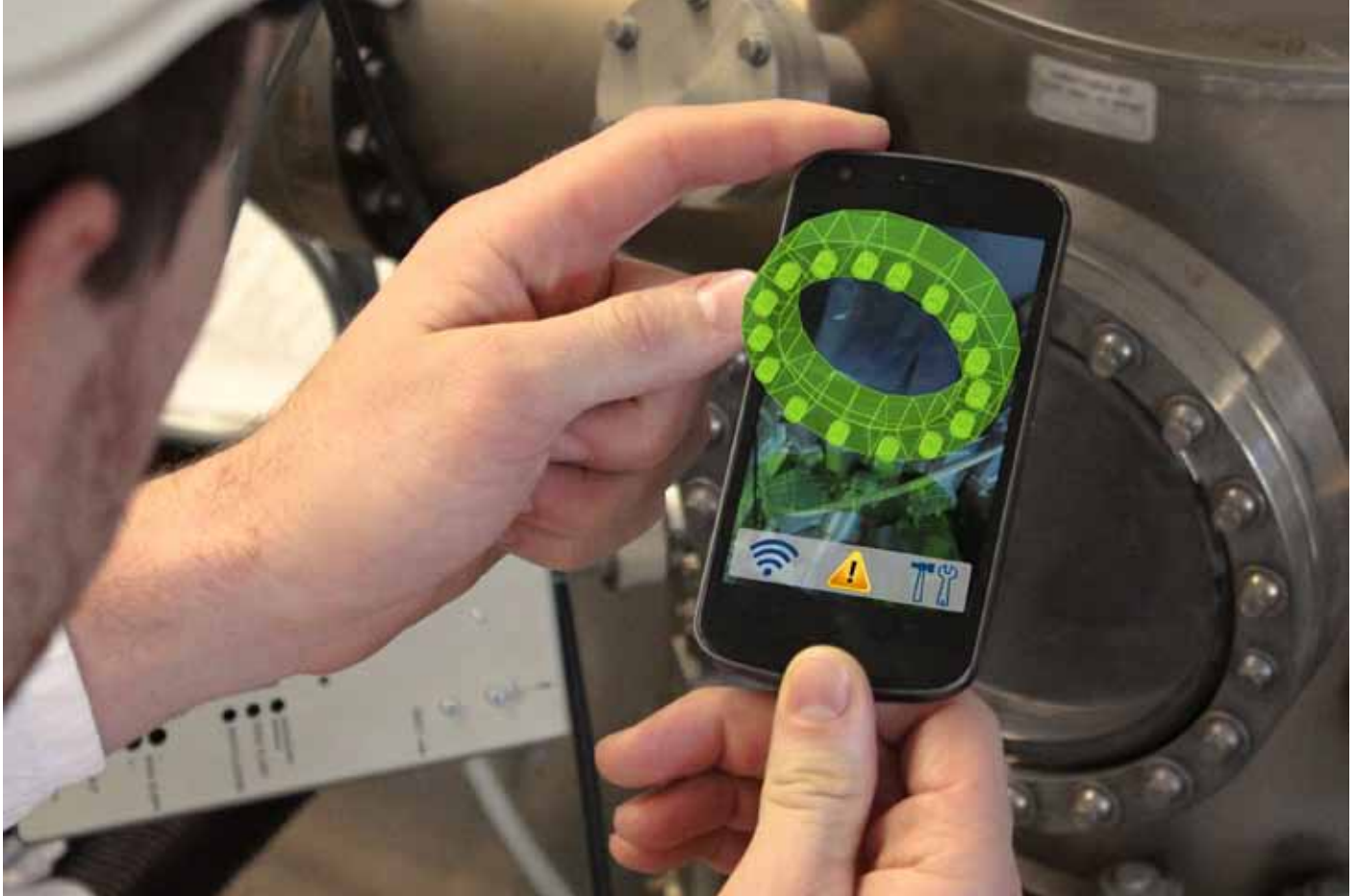
Über ein Smartphone erhält der Techniker anschauliche Anleitungen bei Wartungsarbeiten.
