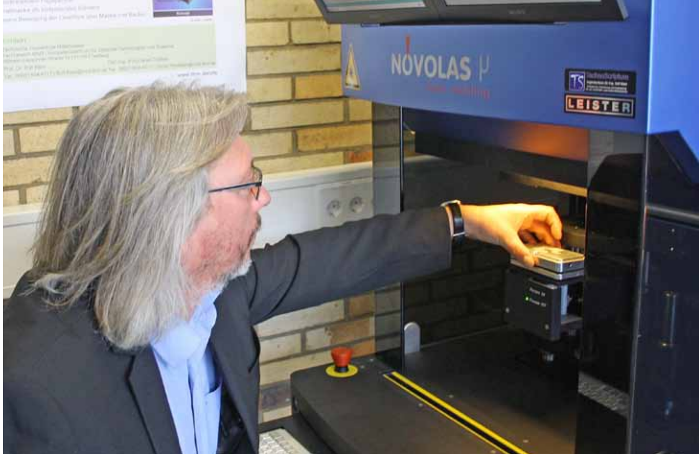
Mit einer Laserschweißmaschine will Prof. Rolf Klein die Bauteile zunächst mit einem Absorber versehen und dann flüssigkeits- und gasdicht abschließen.
