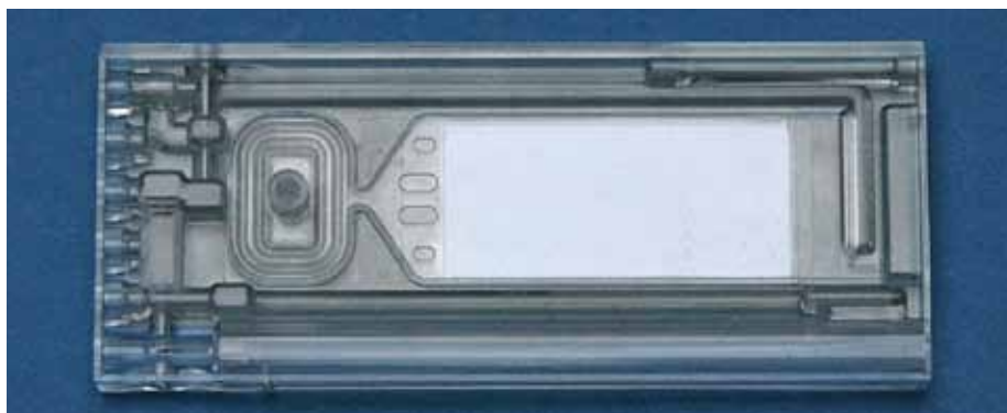
Ein Mikrokanalbauteil, wie es zum Beispiel in der Medizintechnik oder Umweltanalytik zum Einsatz kommt
