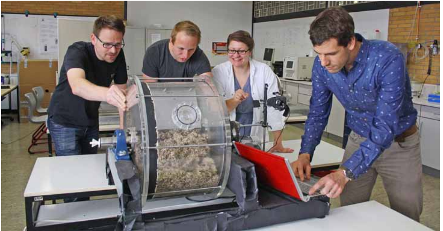
Eine gute Durchmischung der Biomasse ist Voraussetzung für einen hohen Biogasertrag. Mit einem Labormodell optimieren die studentischen Mitarbeiter Helmut Röhner, Gerrit Priester und Katharina Eberle sowie der Wissenschaftliche Mitarbeiter Felix Brück (von links) das Verfahren.
