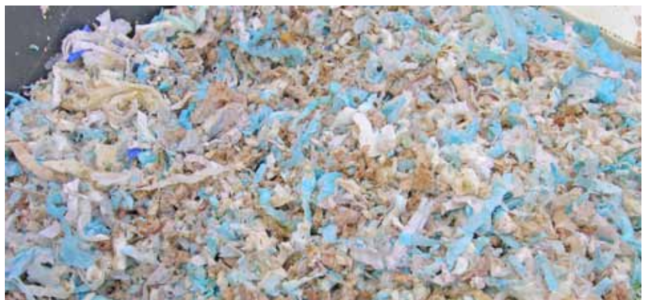
Zerkleinerte Windeln sind der Rohstoff für die Biogasherstellung.
