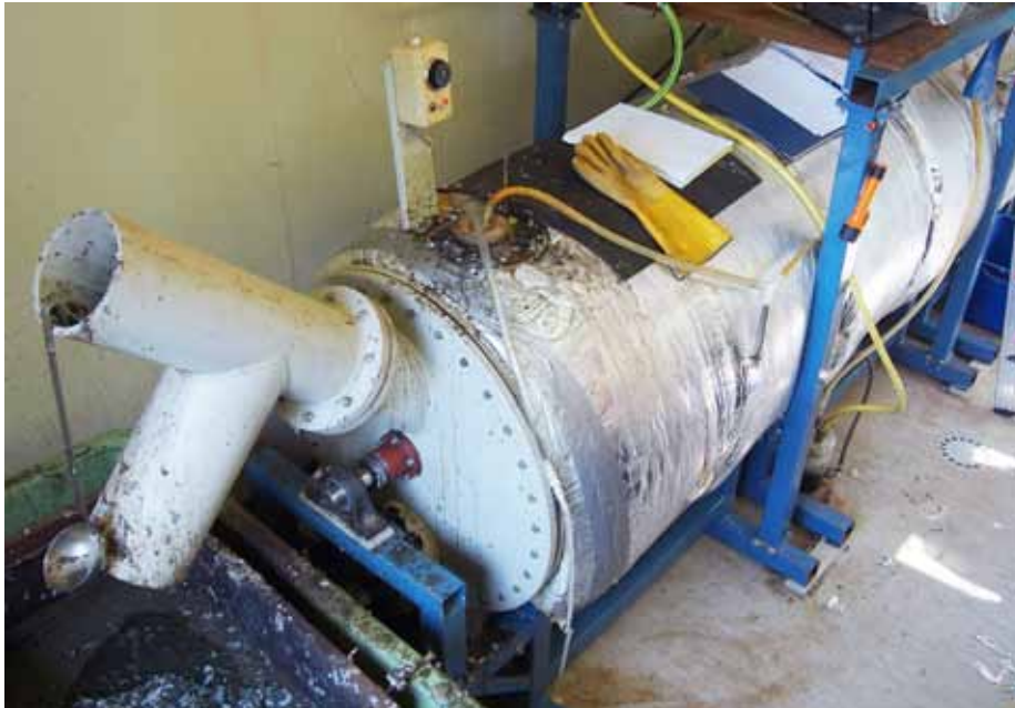
Der Versuchsreaktor zur Produktion von Methan hat ein Volumen von einem Kubikmeter.
