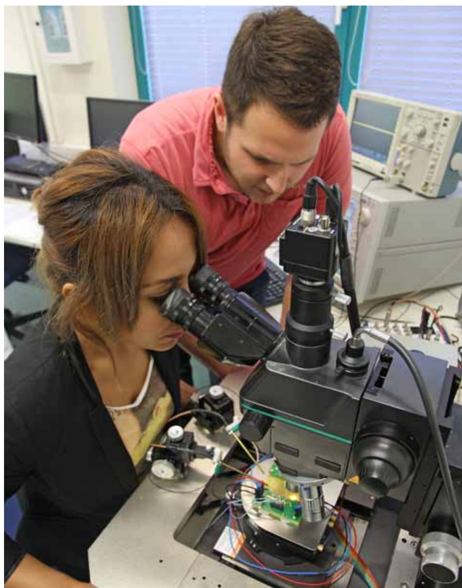
Die Wissenschaftlichen Mitarbeiter Anita Farokhnejad und Fabian Horst testen integrierte Schaltungen am Wafer Prober.
