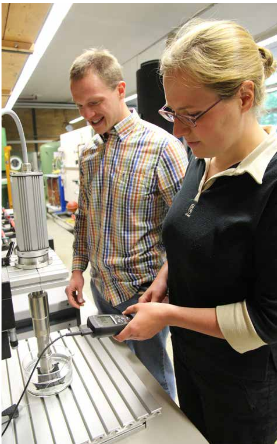
Die Wissenschaftlichen Mitarbeiter Daniel Seipp und Miriam Dill untersuchen die Haftfähigkeit der Beschichtung mit einem Ultraschallgenerator, der etwa 20.000 Schwingungen pro Sekunde erzeugt.
