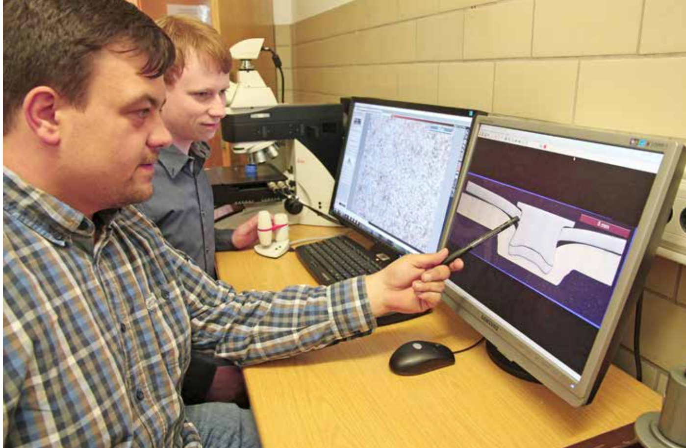
Die Wissenschaftlichen Mitarbeiter René Glück (links) und Maximilian Stähling prüfen eine mikroskopierte Nietverbindung.
