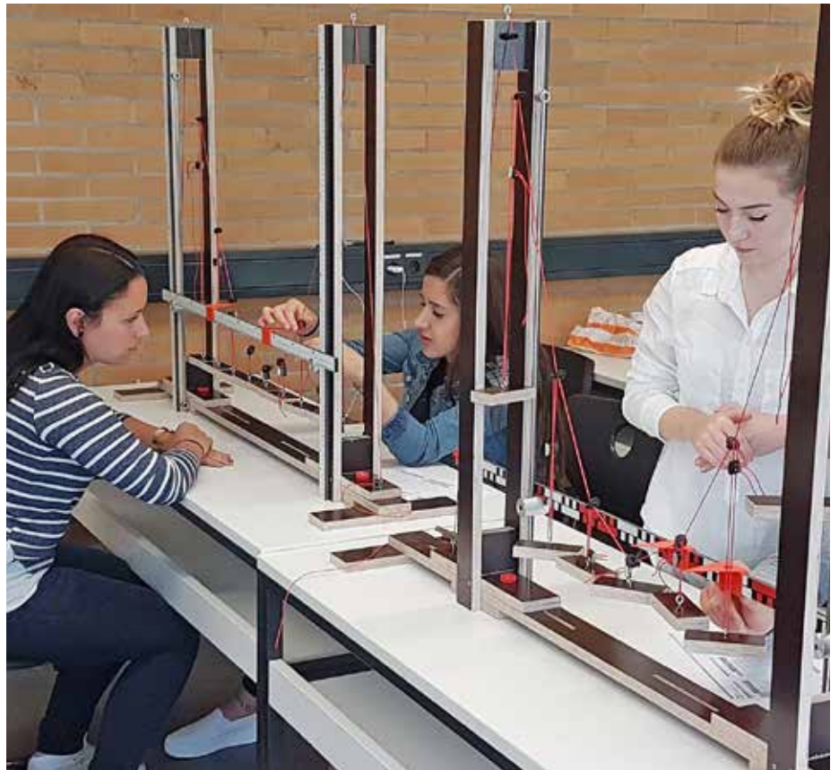
Berechnet und praktisch überprüft: die Kurve des Trageisls einer Hängebrücke
