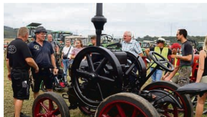
Hingucker: Der Glühkopf-Motor wurde in Reilos oft bestaunt. In der Landwirtschaft war vor allem der zweitakt-Glühkopf-Motor mit einem Zylinder bekannt.
