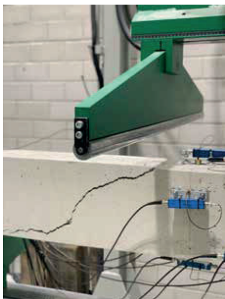
Bei einer der Schau-Prüfungen ging es um die Bruchfestigkeit von Beton.
