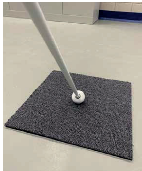
Die RFID-Tags werden vom Blindenstock erfasst und von einem Datenbanksystem ausgewertet.
