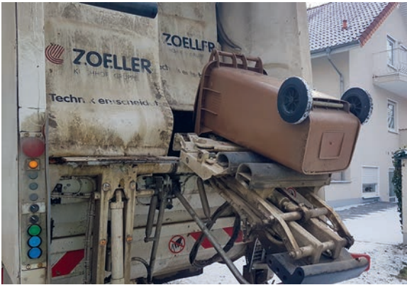
Eingefrorener Bioabfall lässt sich auch durch mehrmaliges Rütteln nicht aus dem Müllgefäß leeren. Foto: AWB Wetterau
