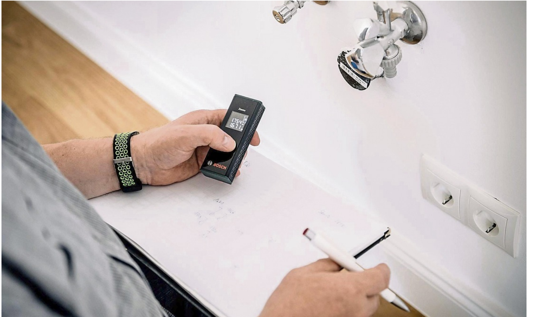
Laser-Entfernungsmessgeräte messen Distanzen in Sekunden aus.
