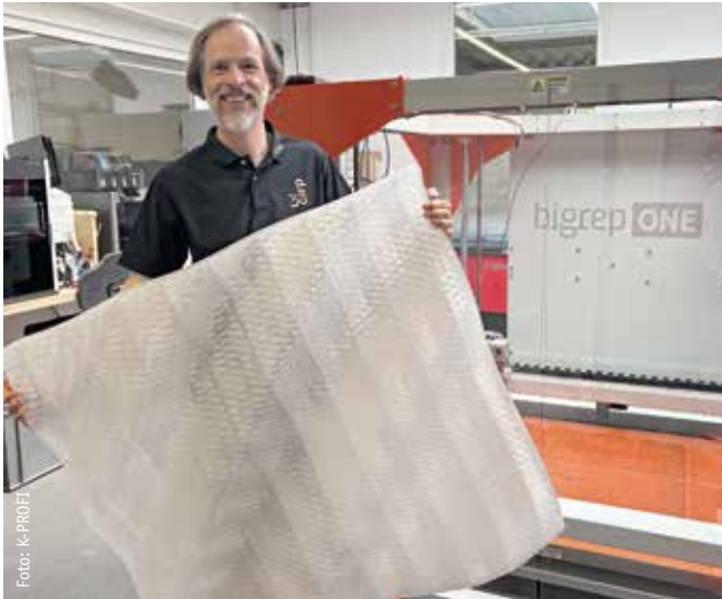
Thomas Lück ist Leiter Vertrieb und Innovation, hier mit PETG-Fassadenverkleidungselement aus dem Großformat-FDM-Drucker Bigrep One, der ein Bauvolumen von 1.000 x 1.000 x 1.000 mm realisieren kann.
