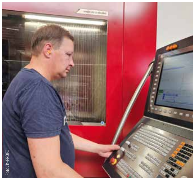
Am 4-Achs-CNC-Bearbeitungszentrum von Hedelius hat einer der Mitarbeitenden gerade eine 17 mm gegossene PA-Platte auf der Maschine liegen ...
