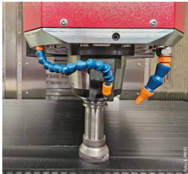
... und plant diese mit einem Messerkopf auf 15 mm Nennmaß ab. Daraus entsteht die Grundplatte für eine Gitterbox.
