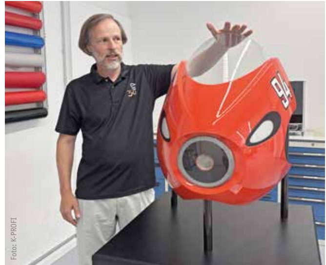
Für diese Motorradmaske erstellte Cirp die Designdaten, konstruierte die Modelle, fertigte die Teile mittels Polyjet-Druck, SLS (Selektives Lasersintern) und Fräsen, lackierte und polierte die Oberflächen und elektrifizierte das Modell.
