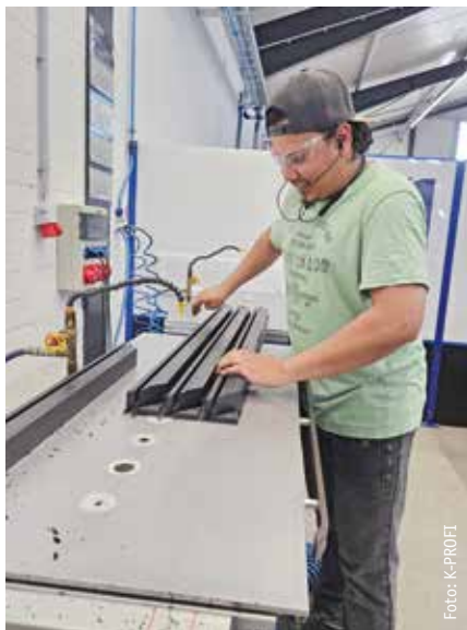
Links: An einer Oberfräse entfernt ein Mitarbeiter die Schwimmhaut um fertig gefräste Leisten.
