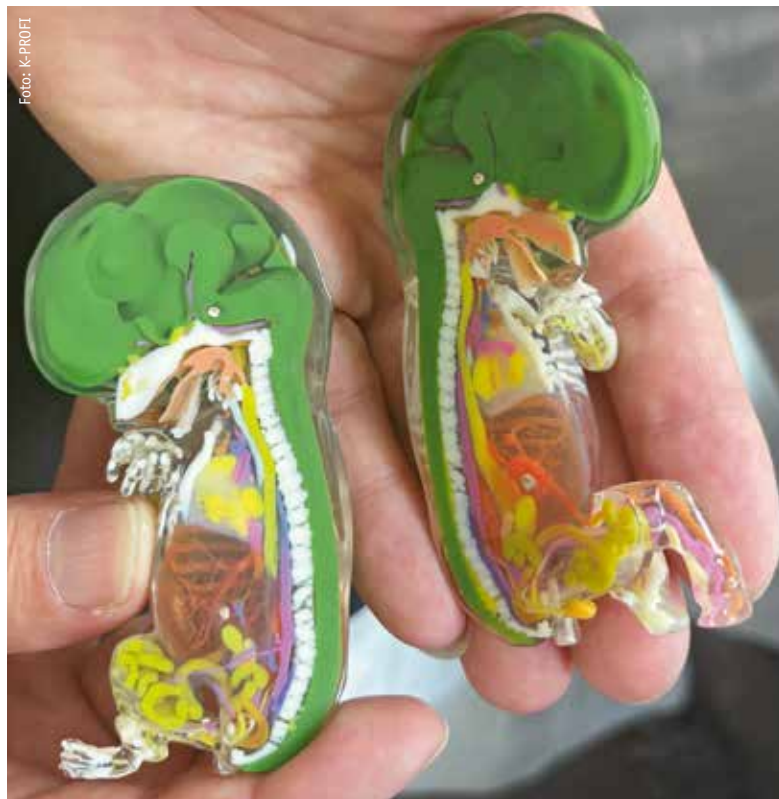
Im mehrkomponentigen Polyjet-Verfahren fertigt Cirp auf Stratasys-Anlagen detailgetreue Embryo-Modelle in verschiedenen Entwicklungsstadien für den Einsatz in Wissenschaft und Bildung.
