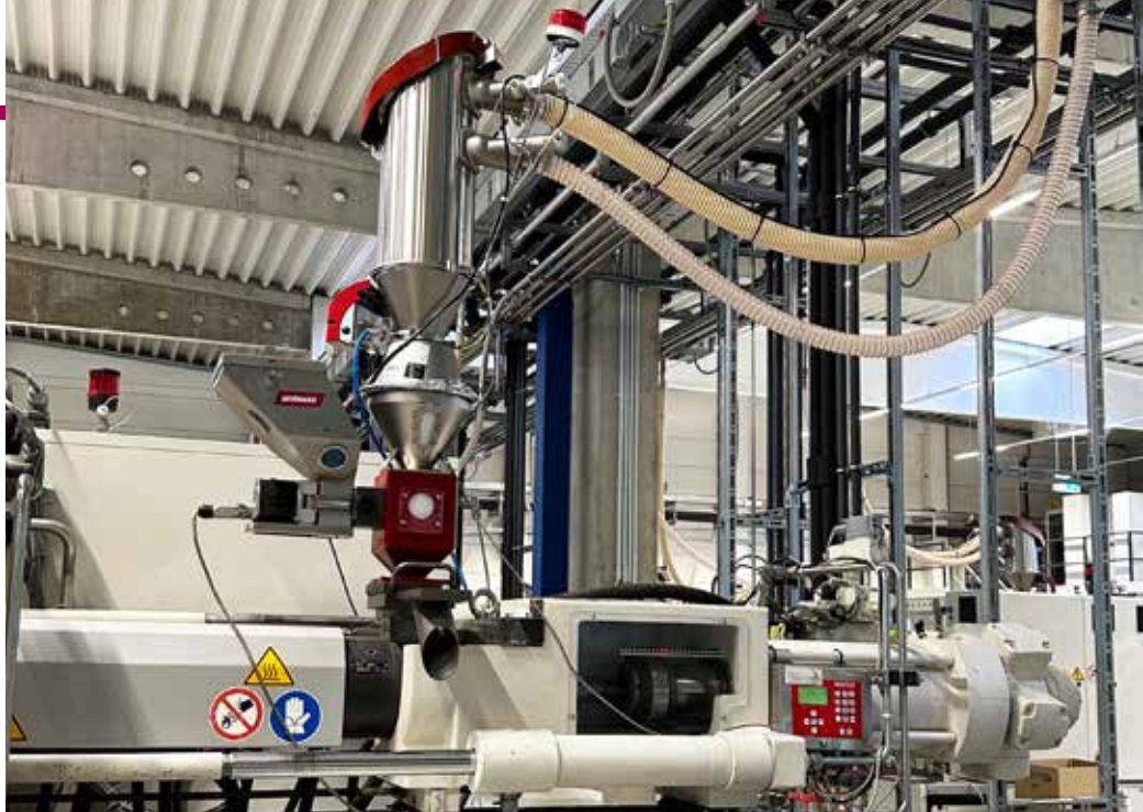
Das Granulat wird im geschlossenen System transportiert. Zudem finden Feedmax Clean Fördergeräte Einsatz. So kommt es zuverlässig nicht zu Staubeentwicklungen.
