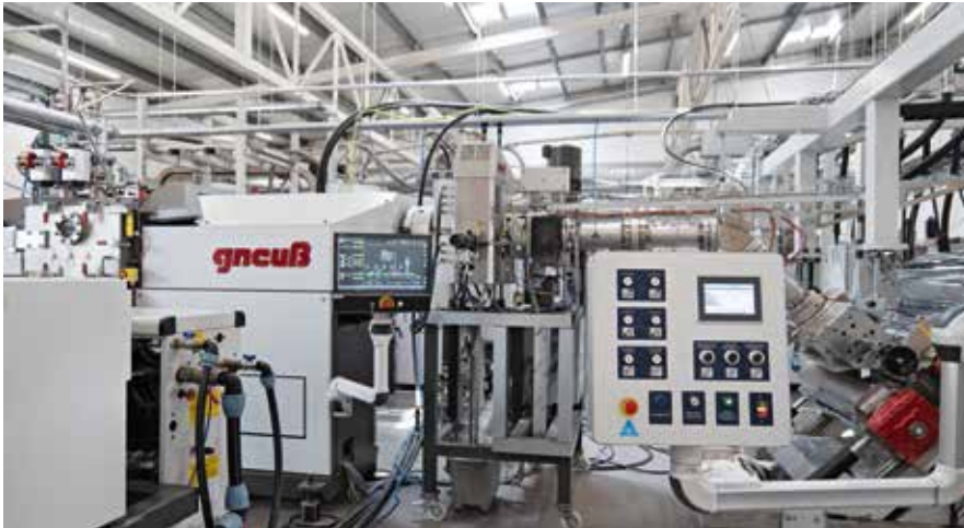
Der Kombination aus einer hohen Entgasungsleistung im Extruder und einer guten Filtration im rotierenden Siebwechsler kann auch Recyclingware nichts anhaben.
