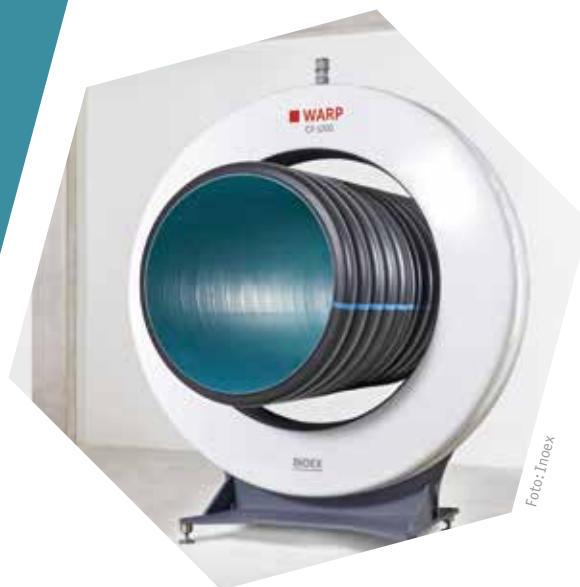
Das Messsystem Warp CP mit acht radarbasierten Wanddickensensoren erfasst sämtliche Strukturen eines Wellrohres.
