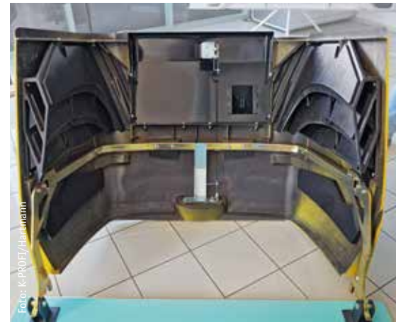
Blick ins Innere der Radlader-Motorhaube: Formtec schäumt Kernlöcher für spätere Gewindeeinsätze im Werkzeugober- und Gewindebuchsen im Werkzeugunterteil sowie spritzgegossene Stehbolzen für die Stahlrahmenbefestigung direkt mit ein.
