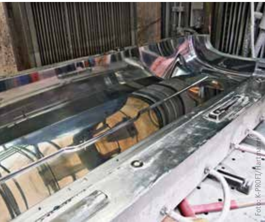
Das PUR-Werkzeug ist auf Hochglanz poliert, denn hier entstehen im In-Mould-Coating-Verfahren Heckoberteile für einen Caravan.
