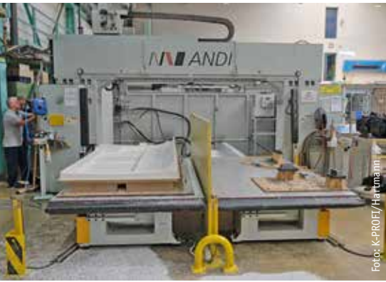
Die CNC-Anlagen sind als Tandem-Maschinen ausgeführt. Müssen sehr große Bauteile gefräst werden, werden die Tische gekoppelt.
