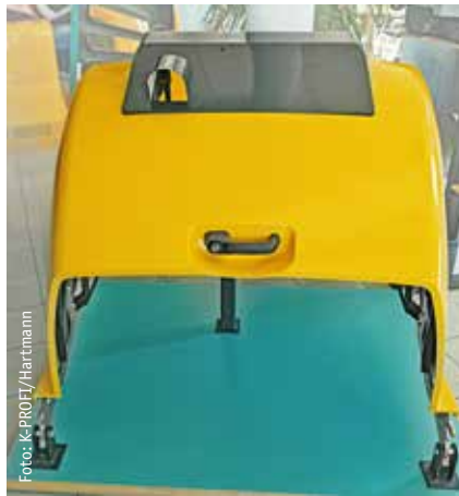
Ein typisches PUR-Bauteil ist die Motorhaube für einen Radlader. Die Oberfläche ist lackiert.
