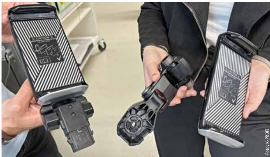
Für den universellen Tablethalter des Rear Seat Entertainment Systems fertigt Funk 3D die Spritzgussteile und montiert diese zur kompletten Baugruppe.
