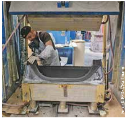
Auf diesen speziellen Formträgern stellt der Werker faserverstärkte PUR-Verbundbauteile her. Derzeit gerade Eintrittsstufen für die Caravanindustrie.
