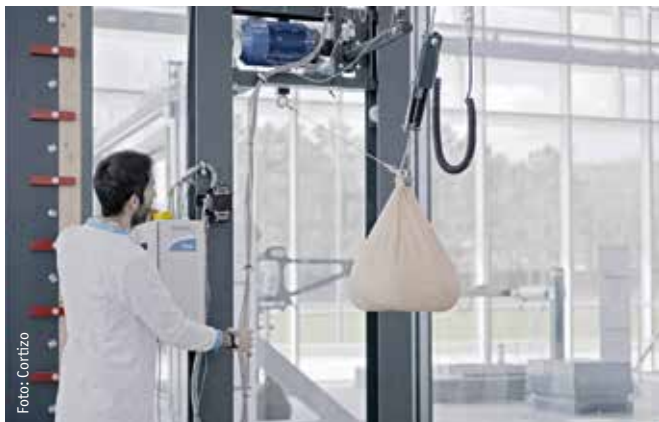
Die Fenster durchlaufen zahlreiche Prüfungen. Hier geht es um mechanische Kennwerte wie Biegemodul, Bruchtest und Schlagfestigkeit.
