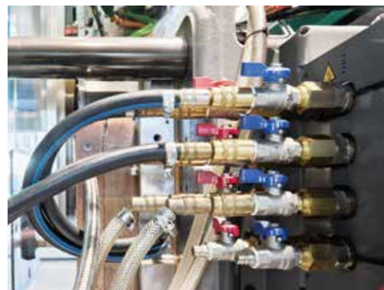
Bei der Fertigung von LSR-Dichtungen im 256-fach-Werkzeug werden die vier Wasserkreisläufe des Kaltkanal-Systems mit dem neuen FlowPilot (hier mit Vierfach-Verteiler) geregelt.
