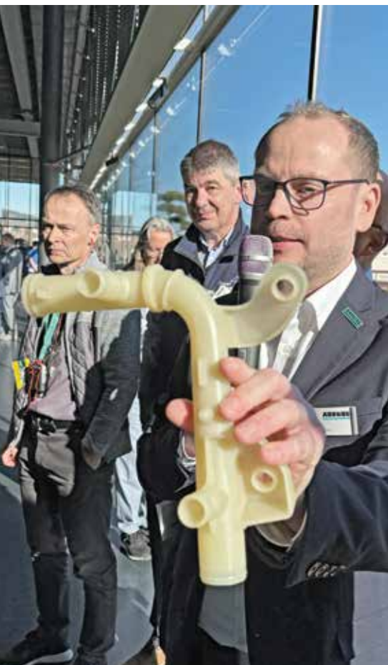
Christian Homp, Gruppenleiter anwendungstechnische Beratung, erläutert, wie das „Multitube“-Bauteil aus einem Vorspritzling entsteht. Beim Fertigspritzen fährt der elektrisch angetriebene Schieber mit eigener Steuereinheit eine Kurve.
