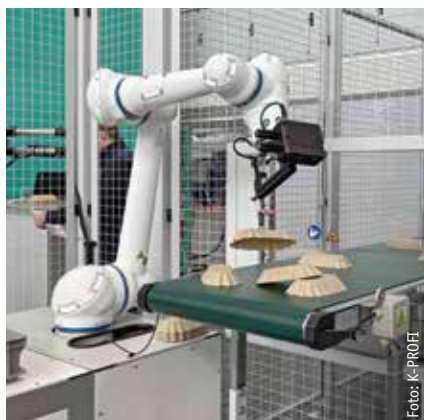
Flexible End-of-Line-Automation: Der autark arbeitende Cobot mit Kamerasystem im Greifer holt Spritzgussteile außerhalb des Schutzzauns vom Förderband, um sie zu stapeln.
