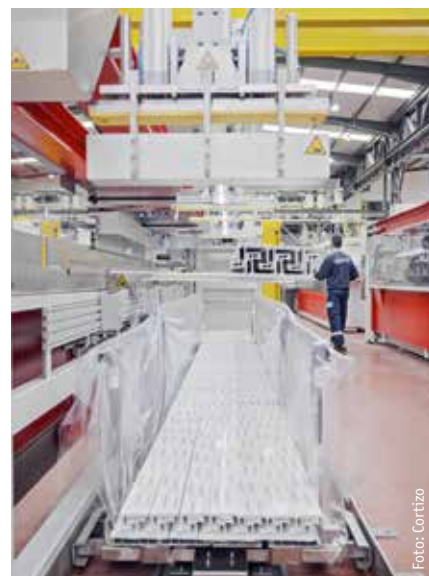
Der „iQ.Stack“ dreht jedes zweite geschnittene Profil um 180°, um die optimale Packdichte zu erzielen.
