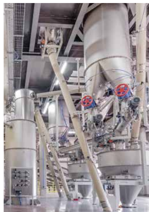
Der Mischbereich ist vertikal angeordnet und basiert auf zwei Grundrezepturen: Einmal weiß mit \text{TiO}_2 , einmal nicht weiß, ohne \text{TiO}_2 .
