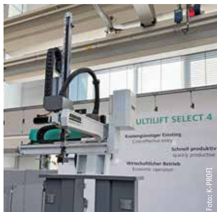
Für einen kostengünstigen Einstieg in die Automationswelt führt Arburg das neue Robot-System Multilift Select 4 mit servoelektrischen Antriebsachsen ein.
