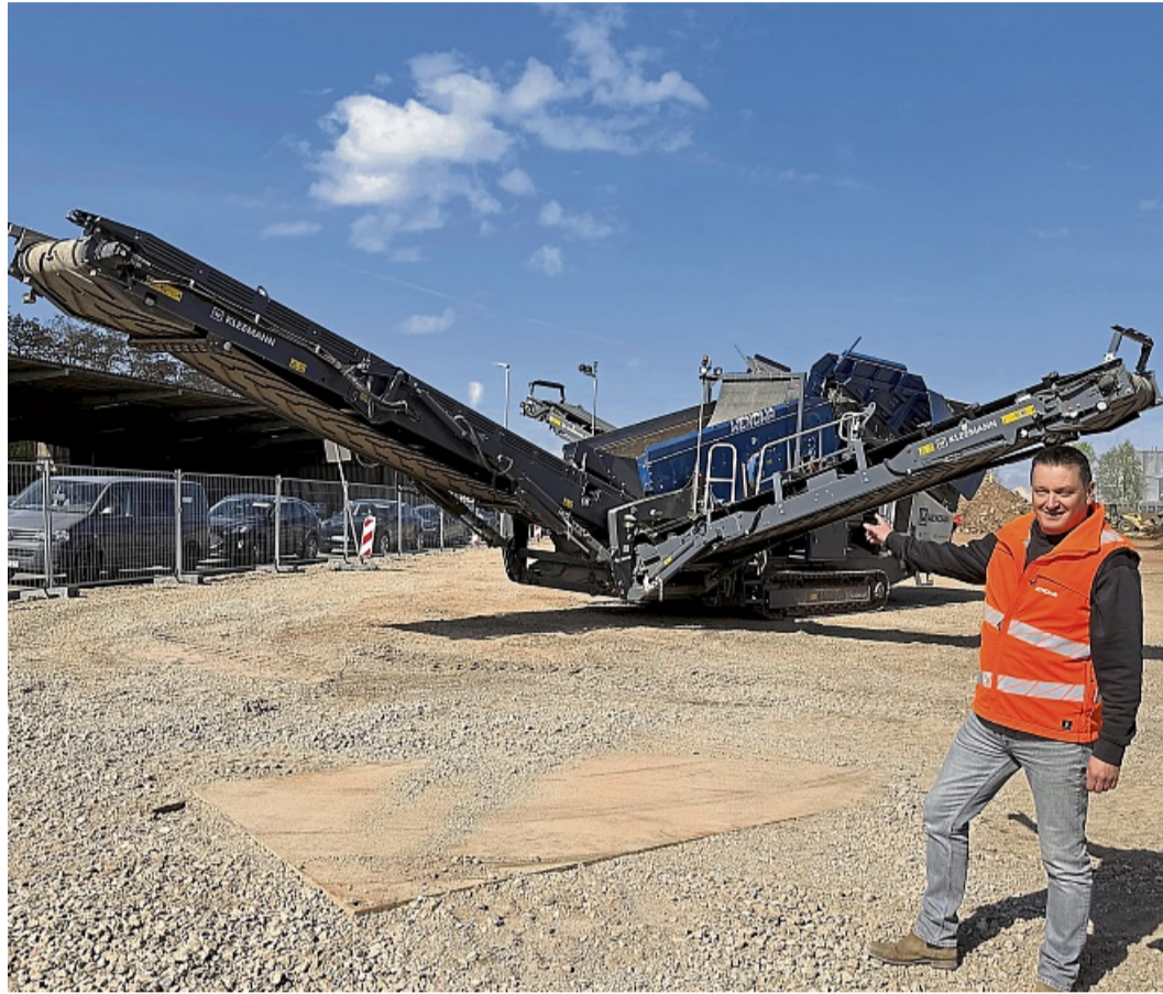
Das kraftvolle Ungestüm im Hintergrund ist ein Betonknacker, mit dem sich Baustoffe zerkleinern und für die Wiederverwertung aufbereiten lassen. Über die Details informierte Wenowa-Betriebsleiter Torsten Stremmel. FOTOS: ELMAR SCHULTEN
