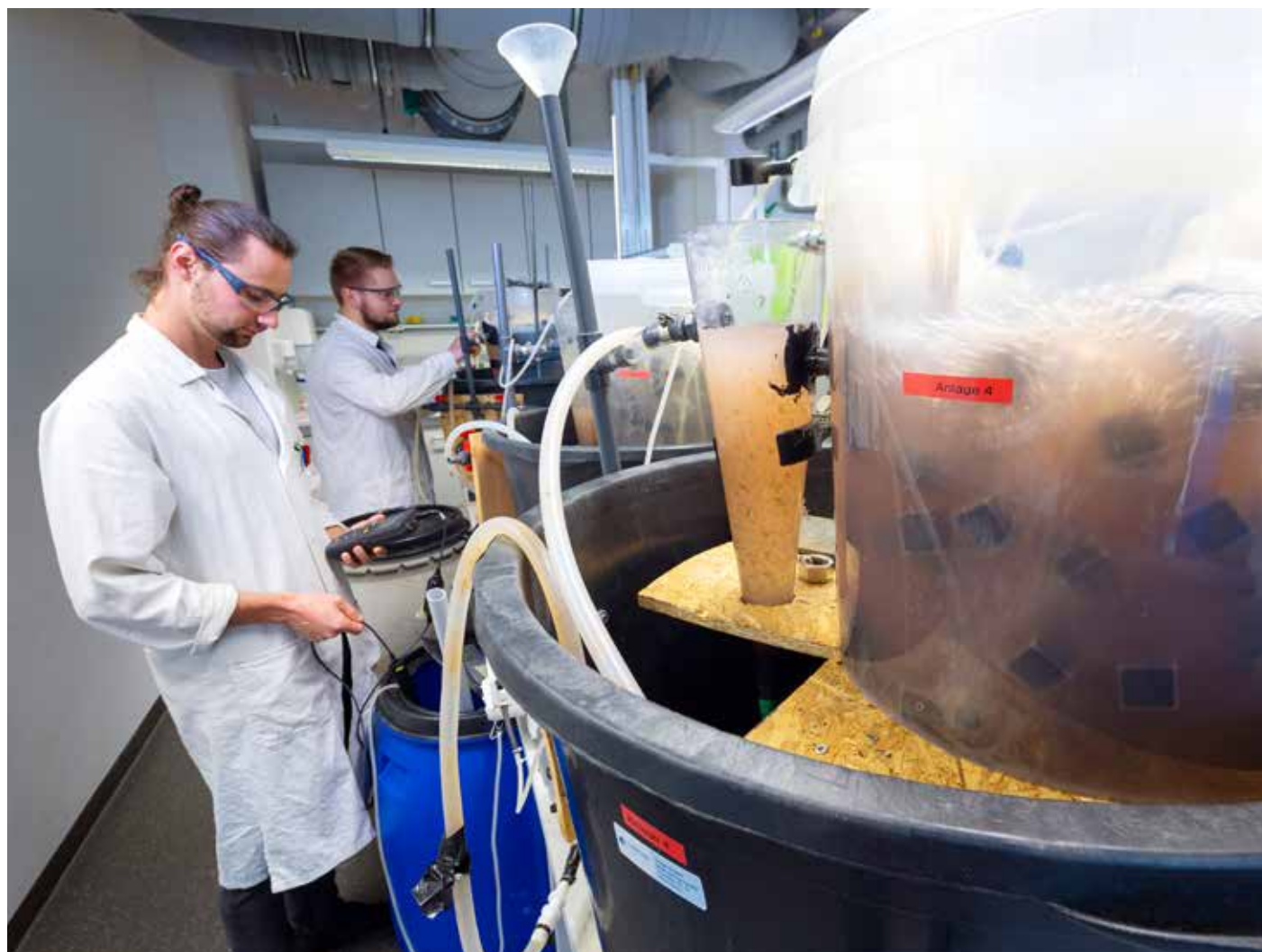
Im Labor der THM laufen parallel weitere Versuche, um die Notfallkläranlage zu optimieren. Nicolas Jost (vorne) und Louis Müller untersuchen unter anderem, wie sich unterschiedliche Würfelmaterialien verhalten.
