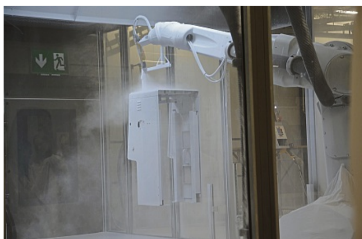
Roboter übernehmen einzelne Schritte in der Produktion im neuen Werk W. Hier werden Gehäuse von Dialysemaschinen pulverbeschichtet.
