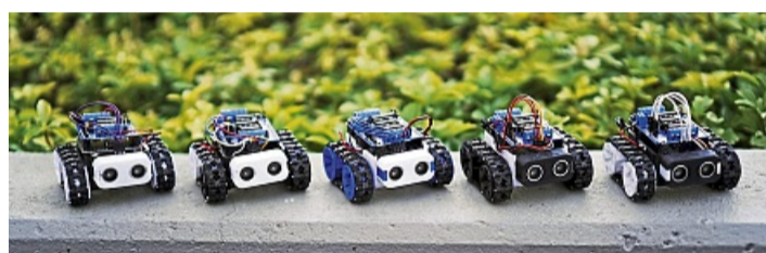
Selbst entwickelt, 3D-gedruckt und programmiert: die „SMARS“-Roboter der Fachoberschule Technik.
