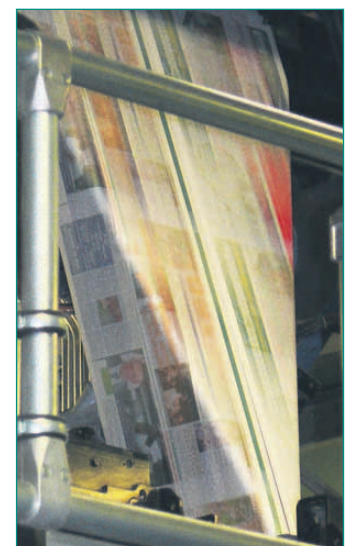
Hochautomatisierter Rollenoffsetdruck: Die Anlage kann bis zu 180.000 Zeitungsexemplare pro Stunde produzieren.
