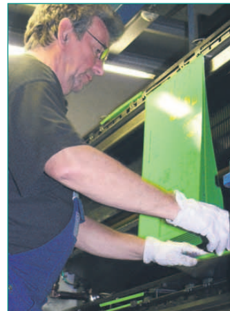
Computer-to-Plate (CtP): Druckplatten werden direkt aus digitalen Daten erstellt, ohne Filmvorlagen.
