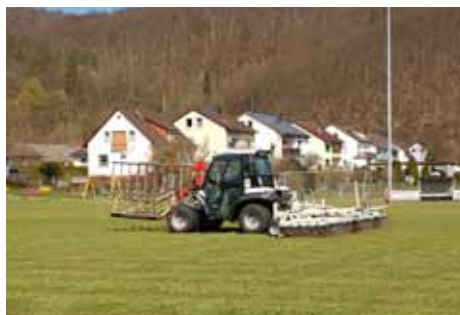
Mit Spezialgerät wurde der Boden gelockert und der verfilzte Rasen gelöst
