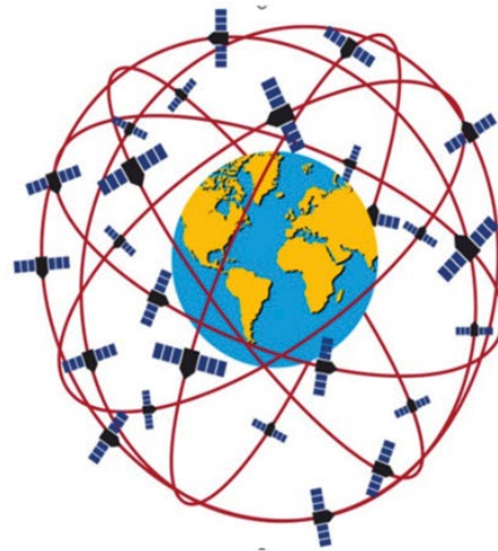
Abb. 3: Konfiguration der Satellitenorbits im GPS https://seos-project.eu/GPS/GPS-c01-p03.html
