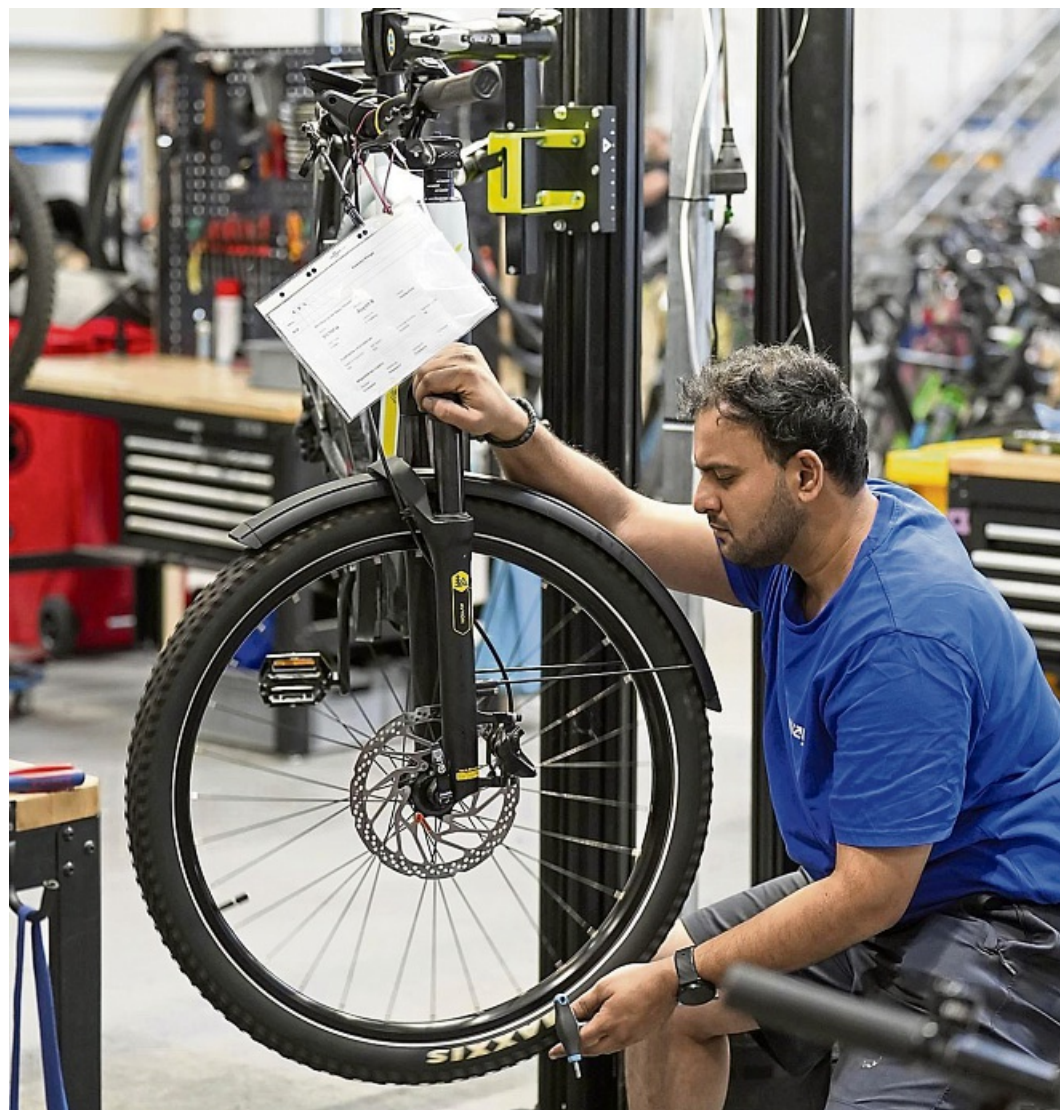
Bei der professionellen Aufbereitung werden E-Bikes komplett überprüft. Dabei entsteht auch ein Inspektionsbericht, durch den Schäden und Reparaturen nachvollziehbar werden.
