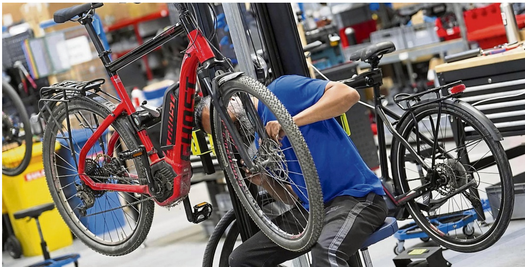
Aufbereitung: Bevor ein Refurbished-Bike in den Verkauf darf, werden auch bestimmte Verschleißteile ersetzt.
