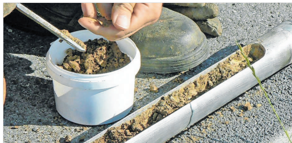
Erdbohrungen in ausreichender Tiefe geben Aufschluss über den Baugrund. Foto: GÜF/Glatthaar Keller
