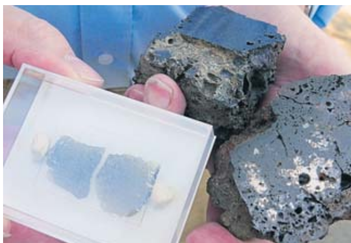
Joachim Lorenz zeigte einen Schlackebrocken, in dem Eisensparten sichtbar sind. Die waren offenbar übersehen worden, ansonsten wären sie im Rennofen verhüttet worden.
