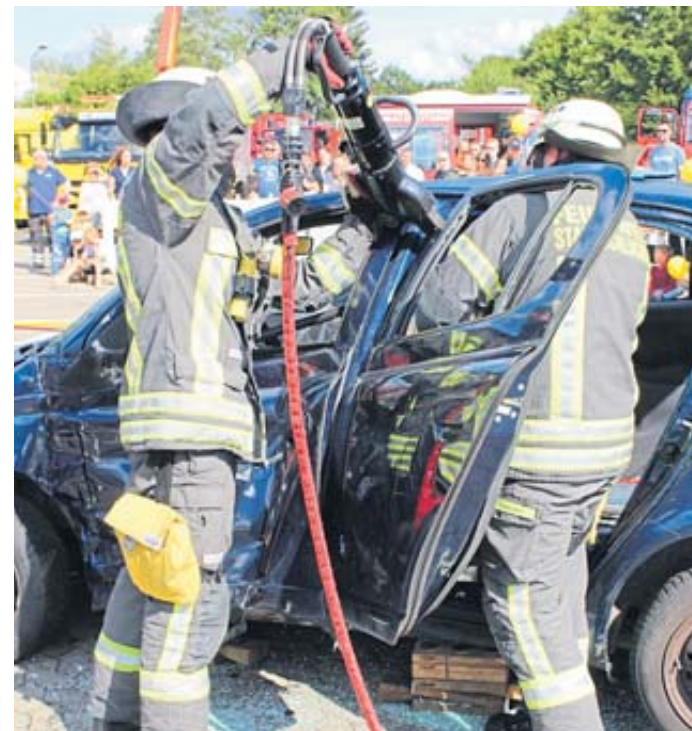
Die hydraulische Rettungsschere kam beim Öffnen des Unfallautos zum Einsatz.
