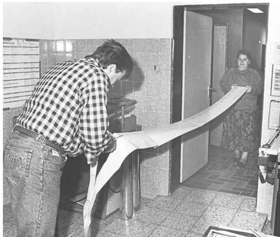
Die entwickelten Papierfahnen mit den Artikeln wurden nach dem Trocknen geschnitten. Im Bild zu sehen ist eine Textfahne mit den kirchlichen Mitteilun-gen, die zu Weihnachten über fünf Meter maß.
