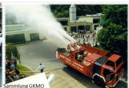
Tag der offenen Tür 27.6.1998 – Ausstellungsbereich Mitarbeiterfeier am Nachmittag davor Turbolöcher mit zwei Larzac- Strahltriebwerken
