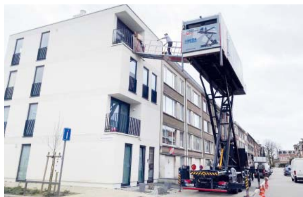
Schafft vier Stockwerke: Möbelcontainer mit Hydraulikheber.
