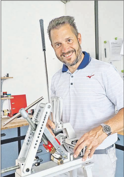
An der Biegemaschine wird der für jeden Spieler korrekte Loft- und Lie-Winkel des Golfschlägers eingestellt. Foto: fch
