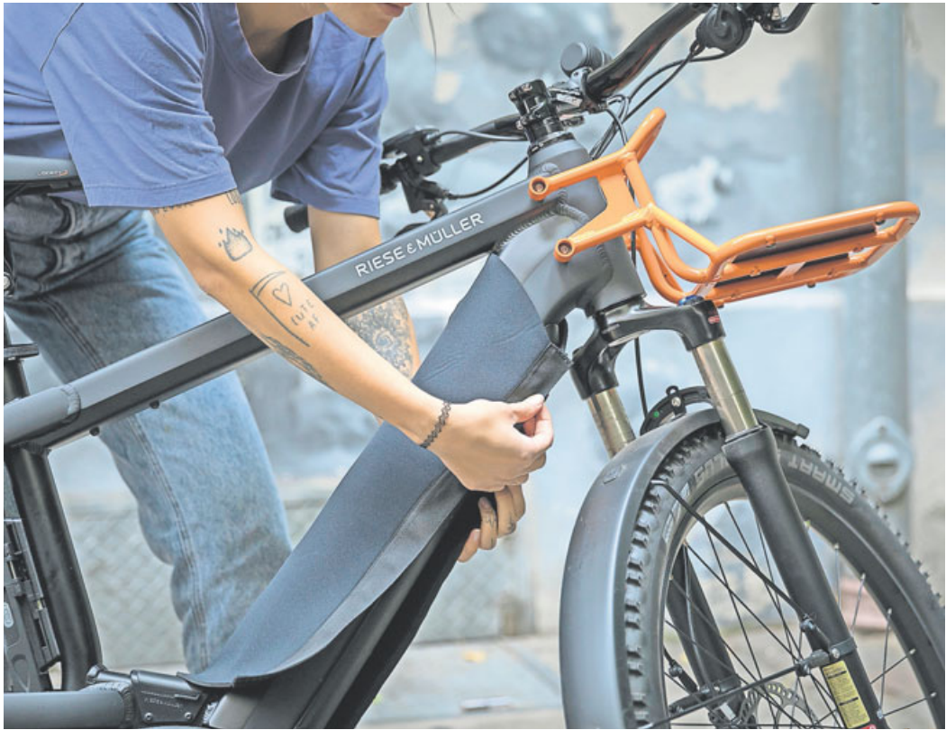
Gut zudecken: Im Winter freut sich der Akku über eine schützende Hülle und dankt es mit weniger Leistungseinbußen. Foto: Florian Schuh/pd-f.de/dpa-mag
