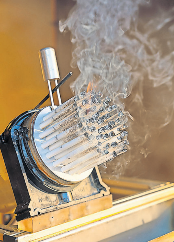
Wie filtern Luftreiniger Zigarettenrauch? Um die Frage zu beantworten, hat eine Qualmmaschine der Stiftung Warentest Normzigaretten kontrolliert abgebrannt.
