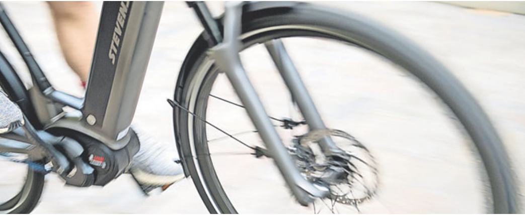
Der Elektromotor von Pedelecs darf seinen Fahrer nur bis zu einem Tempo von 25 km/h beim Treten unterstützen. Foto: Robert Günther/dpa-mag
