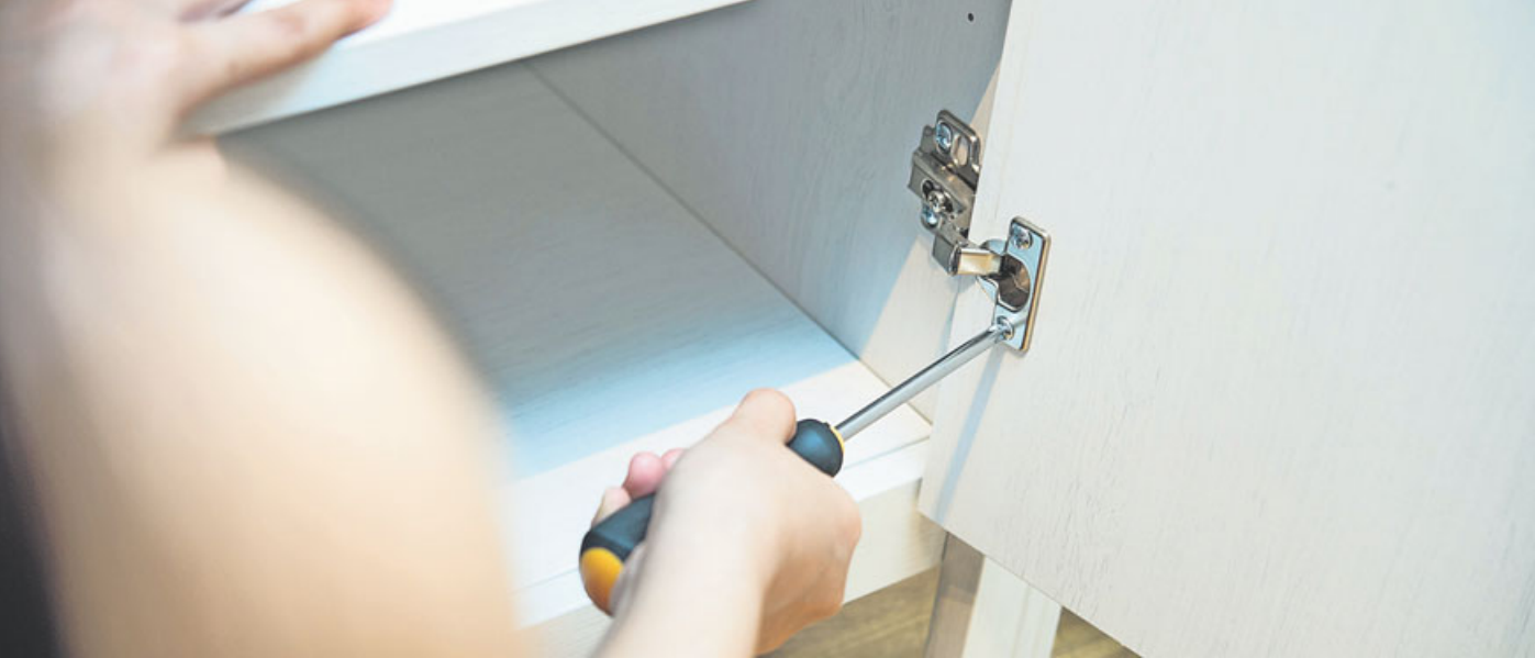
Beim Abbau und neuem Aufbau von Möbeln sind die Scharniere ein heikler Punkt. Sie reißen schnell aus. Foto: Arne Immanuel Bänsch/dpa-mag
