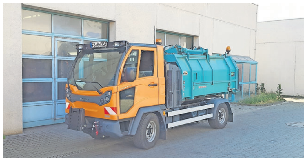
Mit diesen Geräteträgern mit abnehmbaren Müllpressaufbau werden künftig enge und unübersichtliche Straßen zur Abfallentsorgung angefahren.
