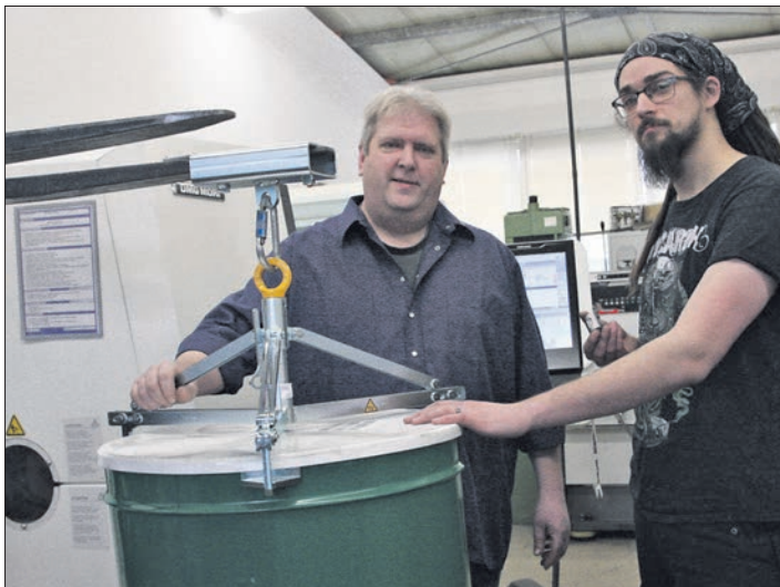
Wevotec-Chef Guido Ernst (li.) und Feinwerkmechanikermeister Thorsten Lohse demonstrieren, wie der Greifer aus Edelstahl am Rand der Tonne angesetzt wird. Foto: Beate Schuchard-Palmer
