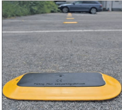
Installierte Sensoren auf einem Parkplatz zeigen einer öffentlich zugänglichen App den Belegungsstatus an. Foto: Smart City System
