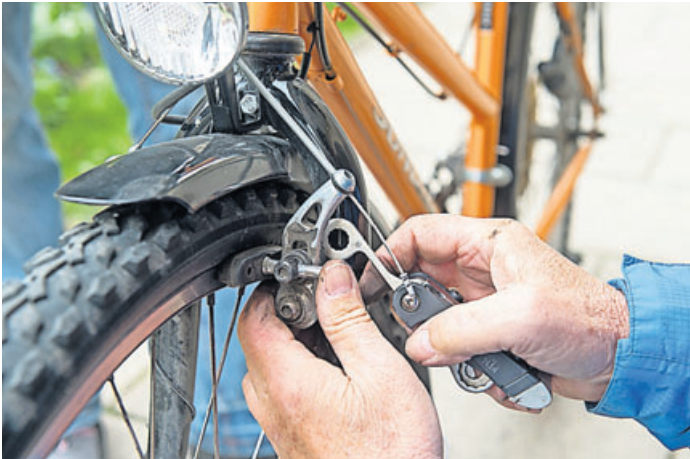
Ordentlich zugreifen: Damit Fahrradbremsen genau das tun können, raten Experten zum regelmäßigem Check und Austausch verschlissener Beläge. Foto: Tobias Hase/dpa-mag
