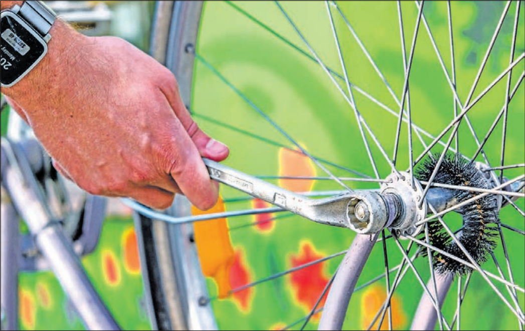
Schaltung, Schrauben und andere Verbindungen können sich mit der Zeit lockern und müssen bei Bedarf nachgezogen werden. Foto: BUND
