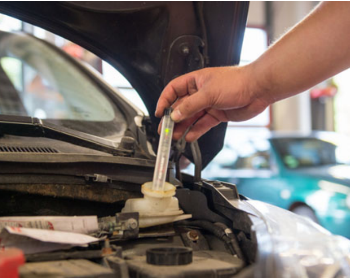
Flüssigkeit im Check: Die Bremsflüssigkeit sollte stets nach Herstellerangaben gewechselt werden. Foto: Inga Kjer/dpa-mag
