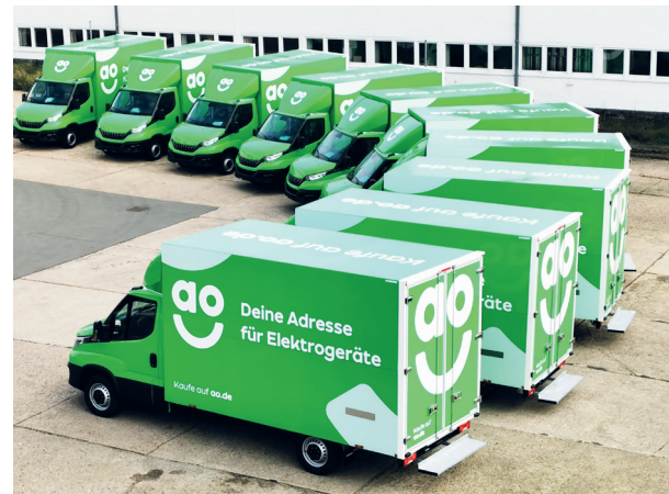
Wiegt nur 350 Kilo: AO setzt auf die „Ultra-Leichtbaukoffer“ von Sommer.
