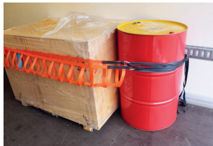
Ein echter Netzakrobat: Dolezychs textile Sperrstange geht wie ein Spanngurt um Kurven und lässt sich variabel im Auflieger an den Zurrpunkten nutzen.
