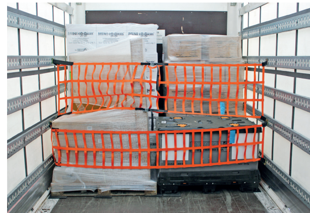
Ein echter Netzakrobat: Dolezychs textile Sperrstange geht wie ein Spanngurt um Kurven und lässt sich variabel im Auflieger an den Zurrpunkten nutzen.
