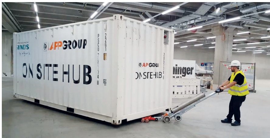
30 Tonnen aus der Schulter ziehen: Der Powerattack von Scholpp soll's möglich machen.
